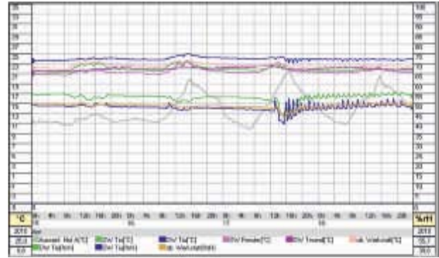
Abb. 19 b: Voll-Heizbetrieb im Raum mit Sockelheizleiste (Ventilstellung 6). Luftbefeuchter schaltet sich erst am dritten Tag ein. Tendenziell ruhiger Klimaverlauf mit geringerer Spreizung als bei Radiatorheizung.
